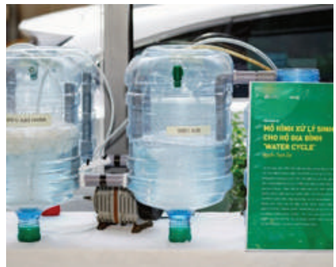
Hình: Mô hình xử lý sinh hoạt cho hộ gia đình "Water Cycle" (Tác giả: Nguyễn Thanh Đức)
